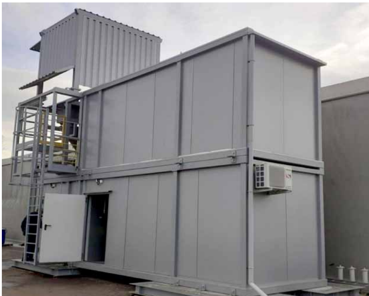
RYS. 6. INSTALACJA MOBILNA DO MIESZANIA I WTRYSKU SORBENTÓW SUCHYCH DO SPALIN W CELU REDUKCJI EMISJI RTĘCI
