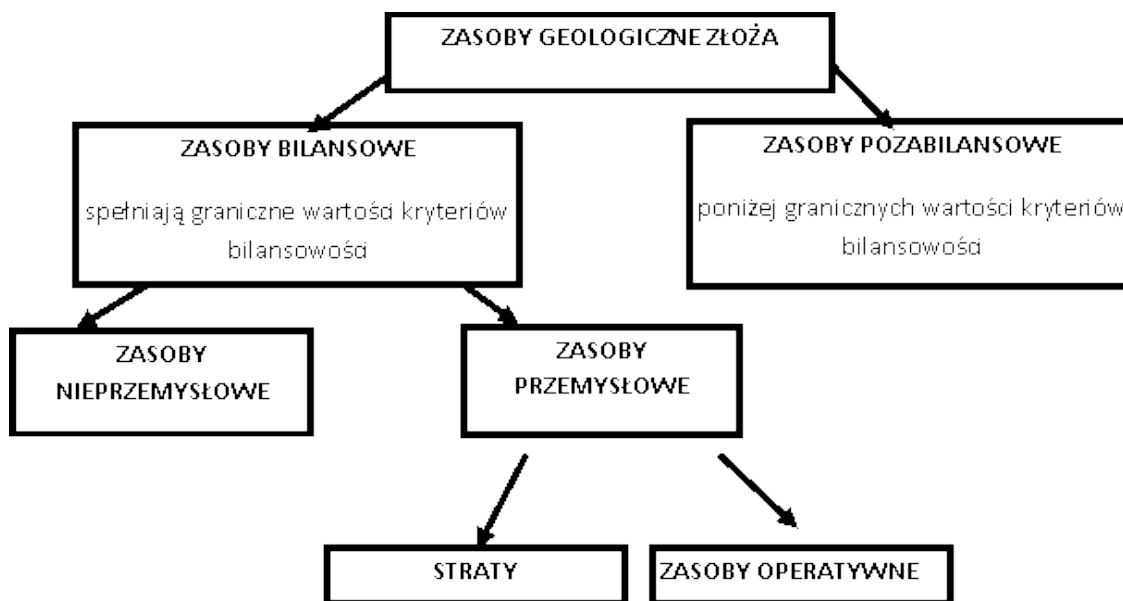
Rysunek 3 Kategorie zasobów w zależności od stopnia dokładności rozpoznania złoża
